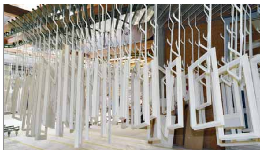
Zur Lackierung setzt Stocker einen Hängeförderer ein.
