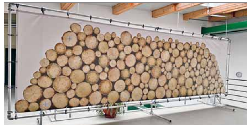
Abbildung 2 Polterleinwand, an der die Systeme unter immer gleichen Bedingungen getestet wurden.
