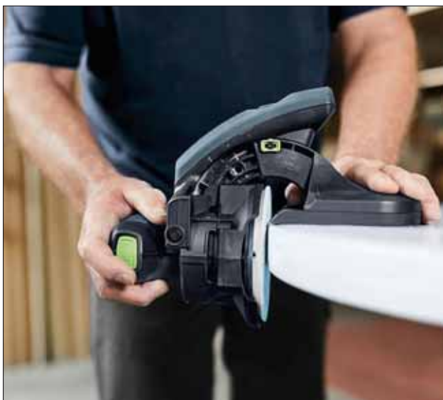
Der neue Kantenschleifer eignet sich für alle Nachbearbeitungen und das Verputzen von Kanten jeglichen Materials oder Beschichtung. Fotos: Festool
