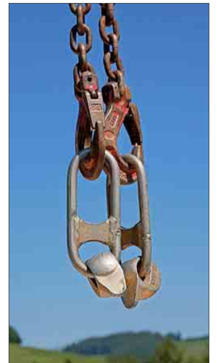
Und schon fliegt das nächste Holzdeckenelement ein (links), das an speziellen Haltevorrichtungen des Krans (rechts) für die Decken- und Wandelemente befestigt wird.
